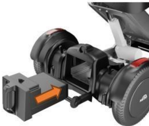
Figura 7-1 Installazione delle batterie
