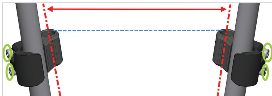
Fig. 3.3.c - Posizione dei collari sui montanti
