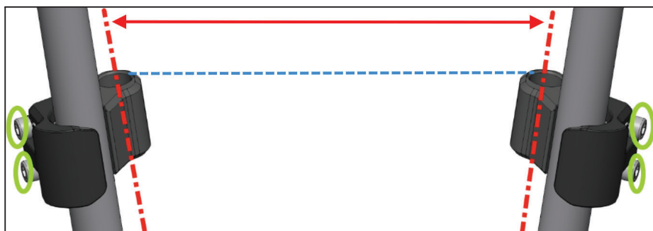
Fig. 3.3.c - Posizione dei collari sui montanti
